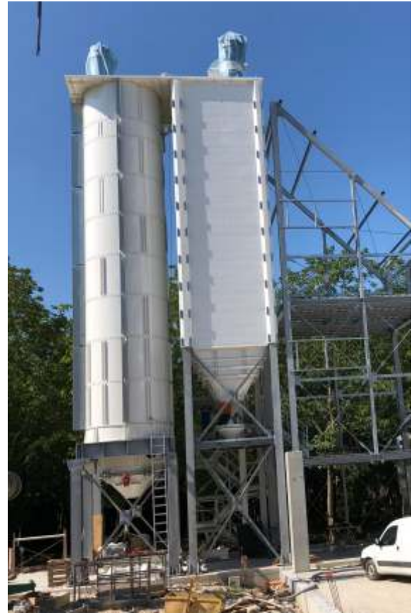
Cella singola a pareti piane sandwich, su struttura metallica, abbinata a cella tonda per farine.
