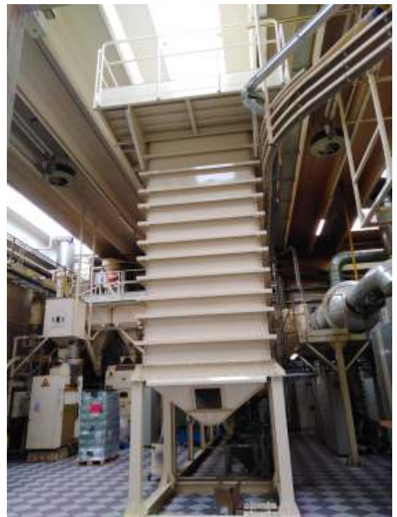
Cella singola a parete liscia con rinforzi a vista, su struttura metallica, per caffè verde.
