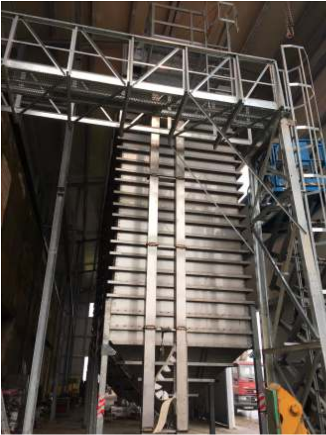
Batteria di celle INOX per riso bianco a parete liscia con rinforzi a vista, su struttura metallica.
